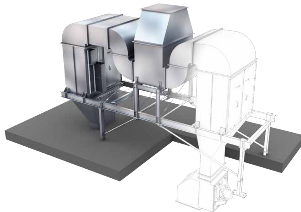
1 // Abluftsystem einer regenerativen Abluftanlage
